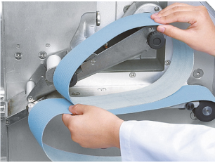
送りベルトは着脱簡単 上下2本の食材送りベルトの着脱は工具不要。簡単に着脱できます。
